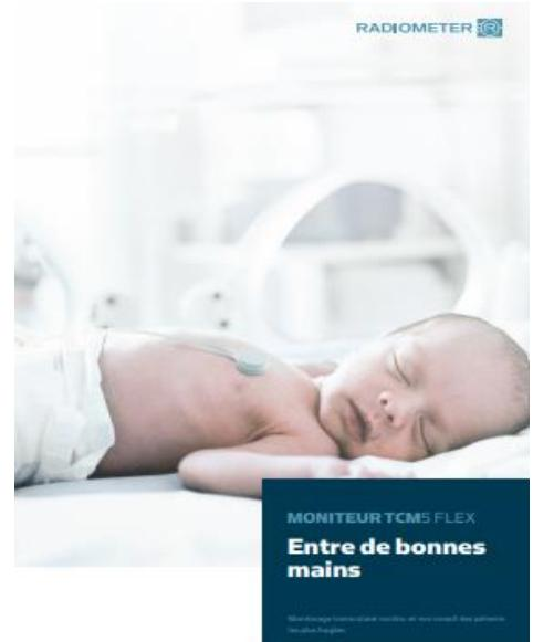
**L'achat de cet appareil de mesure des gaz de sang permettra d'éviter ces prises de sang douloureuses.** Celles-ci seront remplacées par cet appareil équipé de 2 sondes posées à même la peau, elles-mêmes reliées à un moniteur. La mesure est instantanée, et fournit des valeurs en continu.
